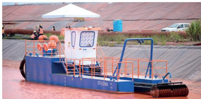
Implantação de nova metodologia de limpeza de bacias e canais no DRS, através de dragagem. Esta inovação possibilita a realização das limpezas de forma remota e durante o ano todo, além de garantir um material final com maior teor de sólidos, o que aumenta a segurança estrutural e ambiental dos depósitos.
